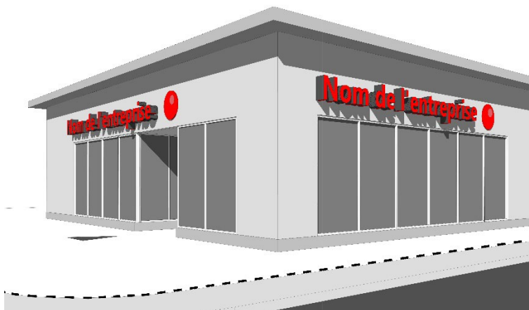
Figure 26 - Démonstration d'une enseigne à plat
